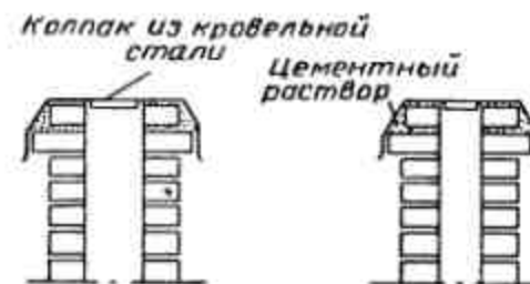
Отделка верх дымовых труб
