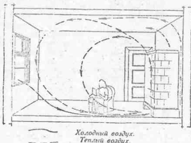
Рис. 9. Воздушное течение при современной кирпичной печи.
