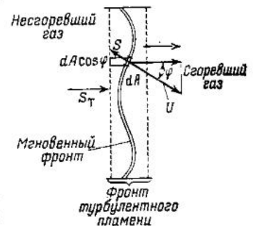
Рис. 7.14. Механизм возникновения пульсаций во фронте пламени (Карловиц).
